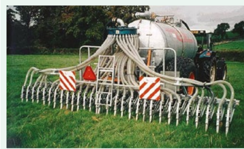
Agregāts šķīdumēslu ievadīšanai augsnes virskārtā. Avots: ZSA arhīva materiāli
