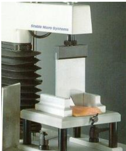
3.3. attēls. Gaļas cietības analizators Warner Bratzler HDP/BSW
