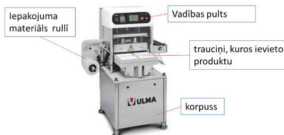
14. att. Periodiskas darbības trauciņu aizkausēšanas iekārta http://www.ulmapackaging.com/packaging-machines/traysealing/smart-300
