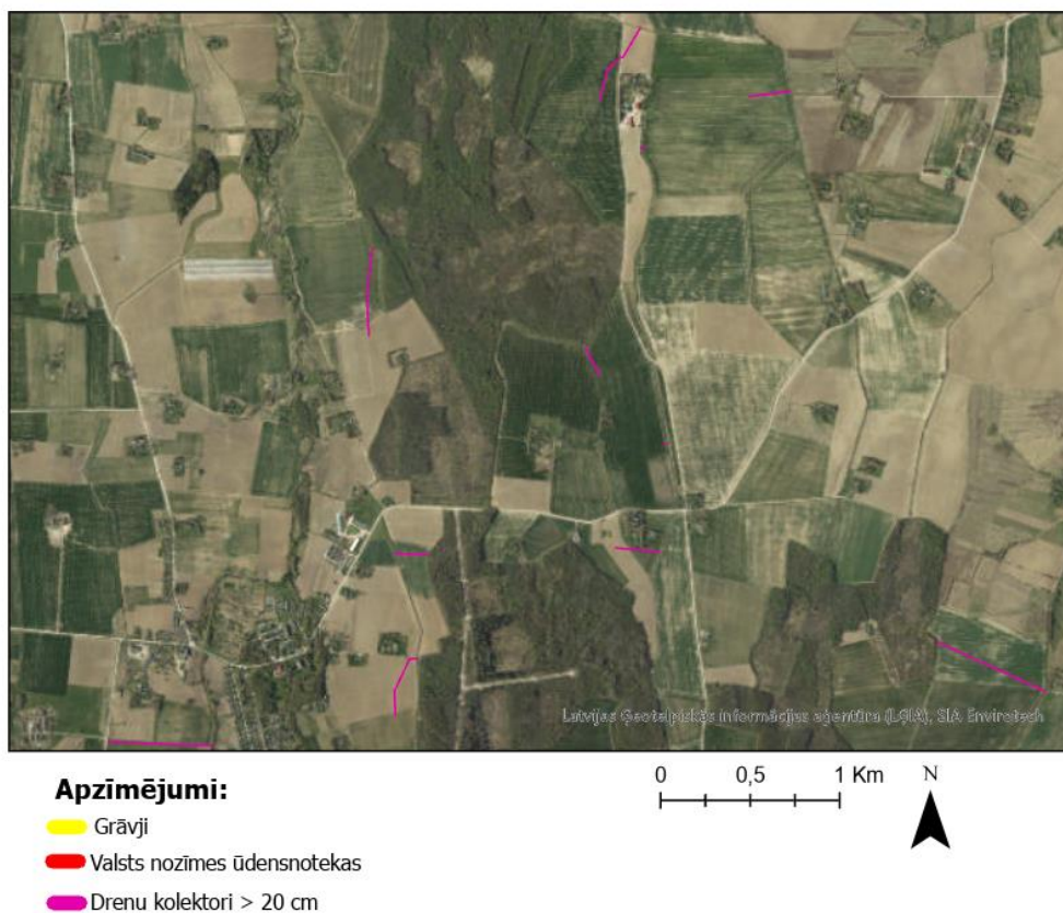
16.attēls. Drenu kolektoru ar diametru virs 20 cm piemērs.
