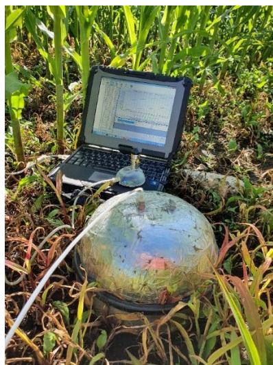
15. att. Diver barometriskā spiediena mērītājs, datu nolasīšanas iekārta un gāzu mērījumu kamera (autors: J.Pilecka-Uļčugačeva).
