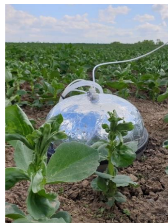
13. att. Kamera gāzu mērījumu veikšanai (autors: J.Pilecka-Uļčuģačeva).
