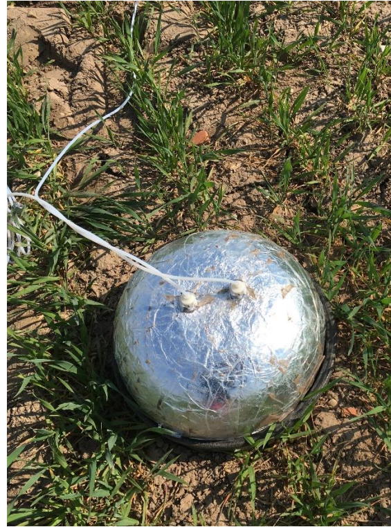
13. att. Kamera gāzu mērījumu veikšanai (autors: J.Pilecka).
