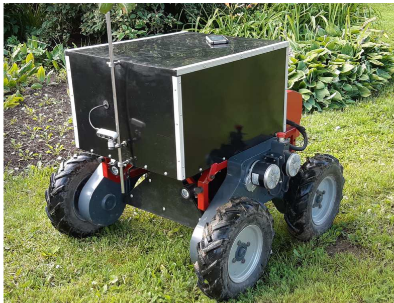
11. att. Sākotnējā platforma, kas pielāgota kultūraugu fotografēšanai.
