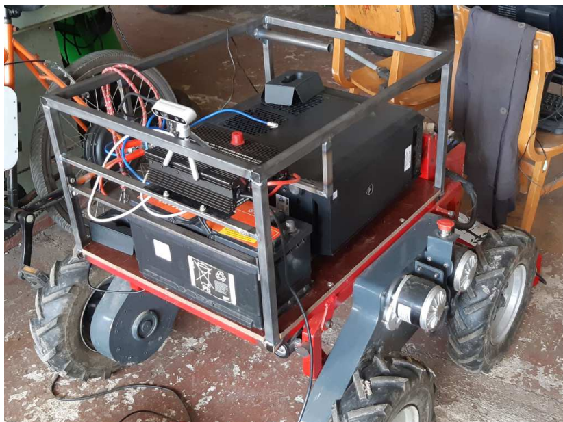
9. att. Korpusa izveide papildaprīkojuma novietošanai.
