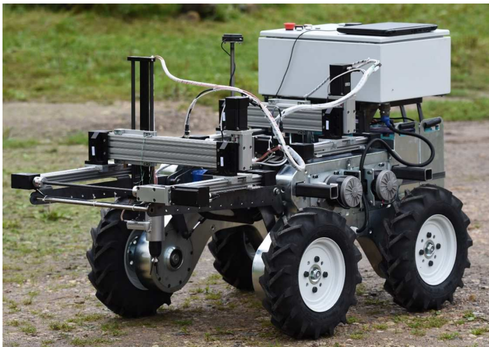
120. att. Darbam sagatavots nezāļu ierobežošanas iekārtas prototips
