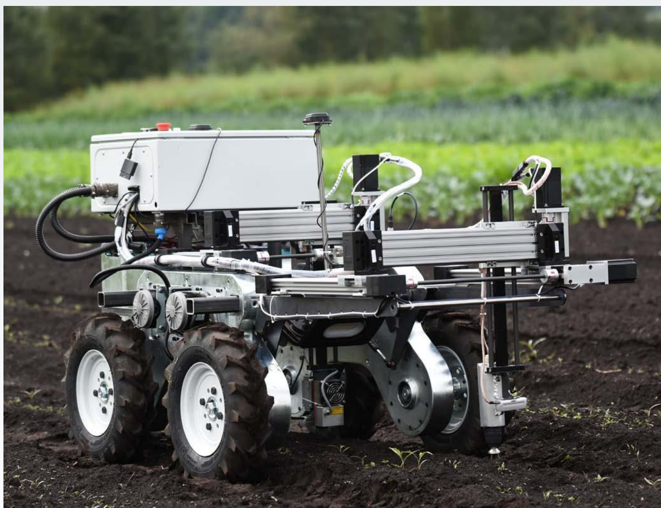
Projekta RONIN ietvaros izstrādātais precīzās ravēšanas robots
