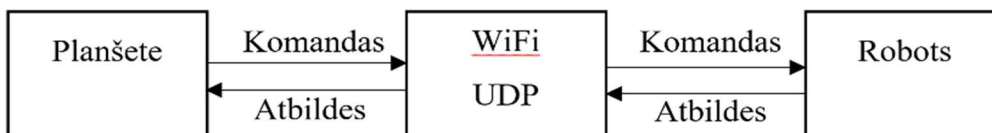
119. att. Planšetes-robotu komunikācijas diagramma.
