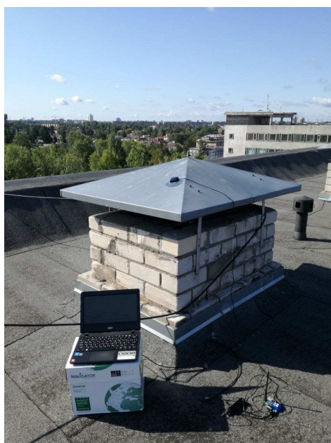
93. att. GNSS-RTK moduļu izmēģināšana uz EDI ēkas jumta pirms uzstādīšanas uz robota platformas
