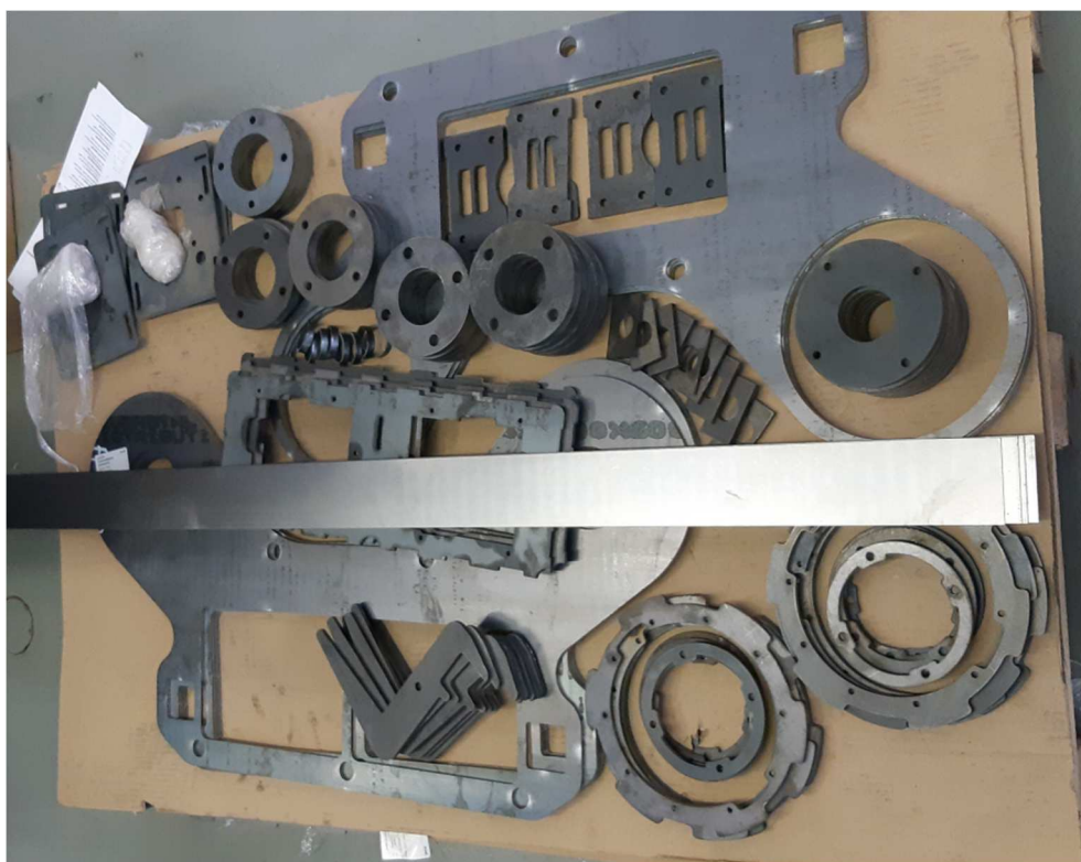
98. att. Ar lāzergriešanas paņēmieni izgatavotās detaļas.
