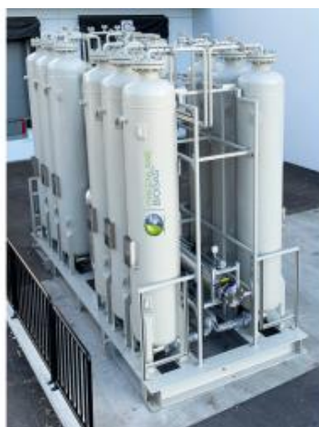
att. 4.1. Ogļskābās gāzes atdalīšana, izmantojot PSA tehnoloģiju 37 .
