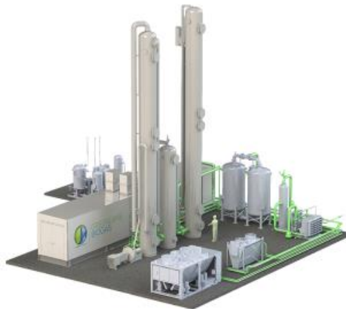
att. 4.4. Biogāzes skalošanas caur ūdeni sistēmas piemērs 40 .
