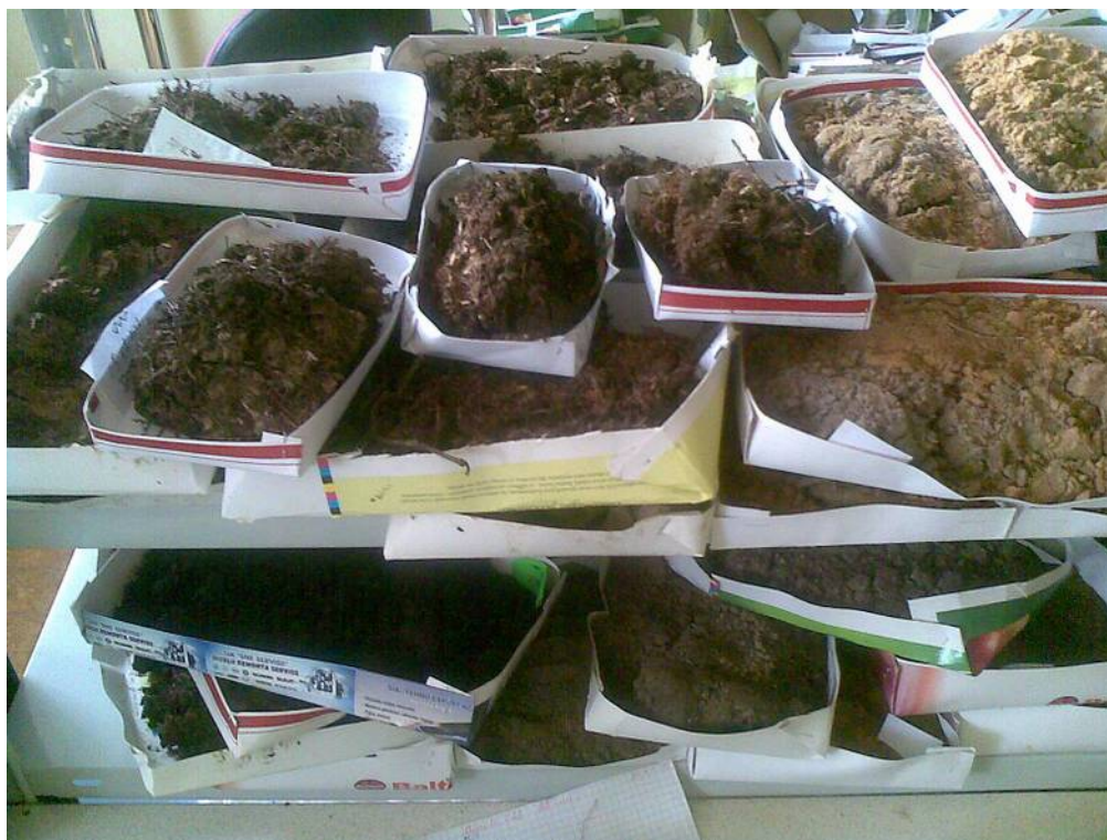
Att. 10: Augsnes paraugu žāvēšana istabas temperatūrā.
